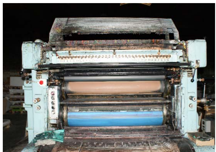
Gli effetti del sinistro incendio sulle apparecchiature della tipografia: contaminazione da fumi e particolato ovunque e fenomeni corrosivi sulle superfici metalliche.
